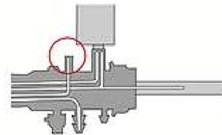
Verbinden Sie den Anschluss 1 mit Teil 1 des Endoskops
