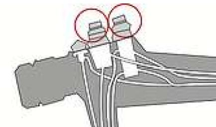
Verbinden Sie den Anschluss 6 mit Teil 6 des Endoskops
