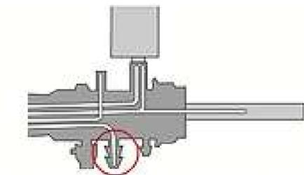
Verbinden Sie den Anschluss 4 mit Teil 4 des Endoskops
