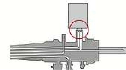
Verbinden Sie den Anschluss 5 mit Teil 5 des Endoskops
